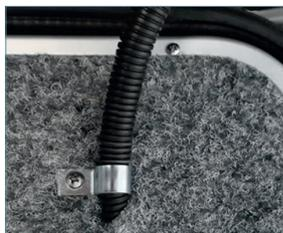
Um Ihre Kabelschläuche zu fixieren, verwenden Sie bitte **Kabelschlauch-Clipsen** oder **Kabelschellen**, wie z. B. die *Berner Kabelschelle DIN 72571, verzinkt, Stahl*
