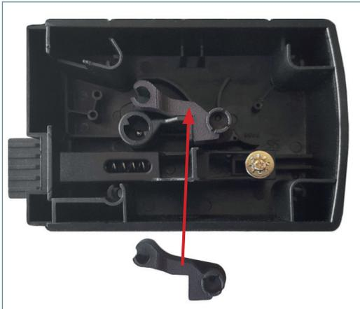
**5. Setzen Sie die Platine mit Aktor in den Schlosskasten ein**
