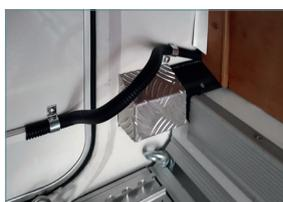
Die Kabelführung an der Stauraumklappe erfolgt, etwa so wie abgebildet, unter einem eventuell vorhandenen Teppich oder ebenfalls mit flachen Kabelkanälen.
