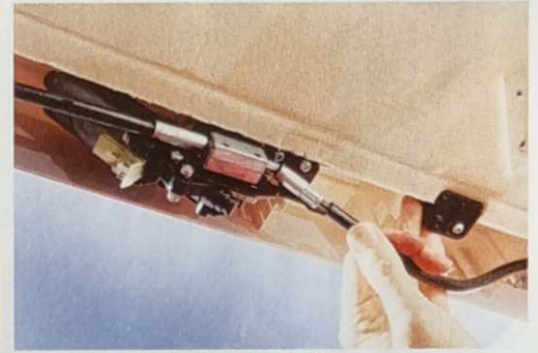
12 ... vielen Haltekralen des Dachfensterrahmens. Dann werden die Wellen wieder aufgesteckt.
