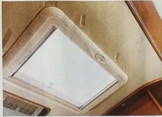
2 Ausgangspunkt: Das Heki-3-Dachfenster, dessen Kurbel und Innenrahmen demontiert werden müssen.
