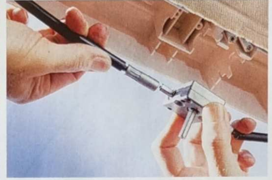
9 Dann löst man die Antriebswellen vom bislang manuellen Getriebe des Heki-Dachfensters.
