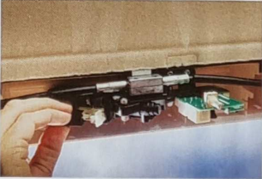
☑ Damit Motor und Steuerung zusammenarbeiten, werden sie über Kabel und Stecker verbunden.
