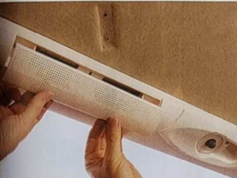
4 An die Rahmenschrauben kommt man nach dem Ausclipsen der Lochblenden.
