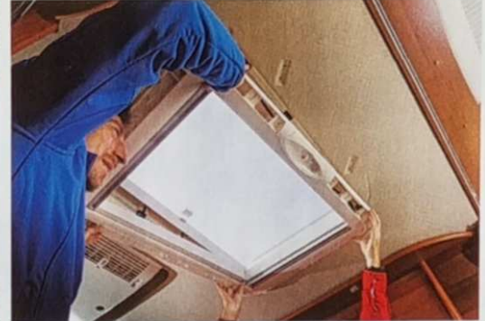
6 Jetzt lässt sich der Innenrahmen ganz abnehmen. Als Nächstes fahndet man nach Stromleitungen ...
